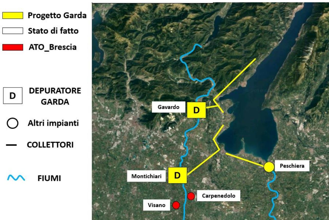
Figura 2: Scenario 4 (Pes+Gav+Mon): rappresentazione schematica del tracciato del nuovo sistema di collettamento e dell'ubicazione dei depuratori a servizio dell'interno bacino
