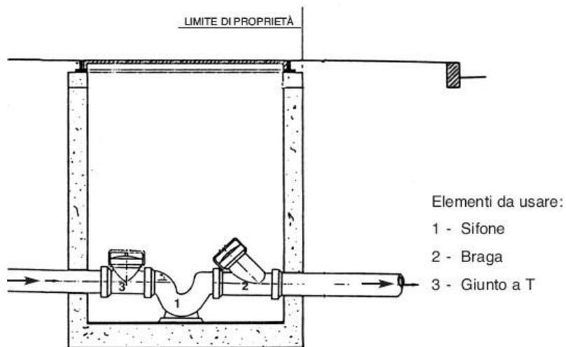
POZZETTO DI DECOMPRESSIONE POMPE
