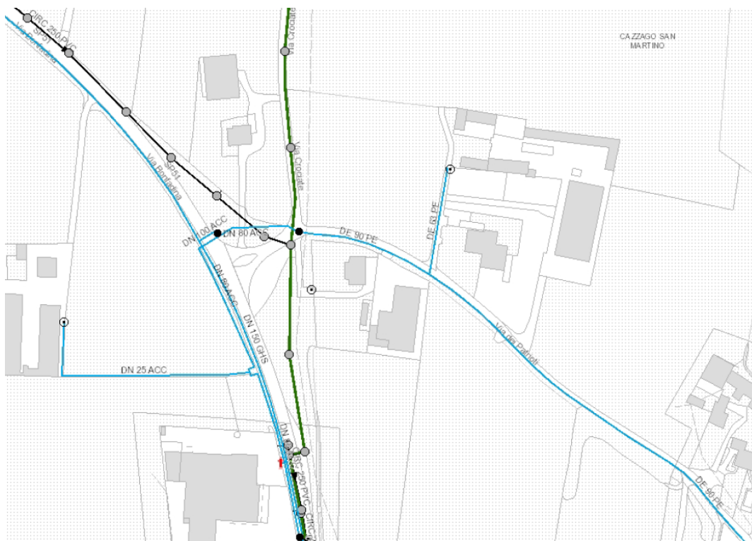
Figura 3 – Stralcio planimetrico rappresentante la rete fognaria esistente, Comune di Cazzago S.M. – loc. Perosino
