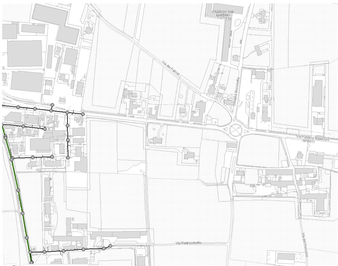
Figura 3 – Stralcio planimetrico rappresentante la rete fognaria esistente, Comune di Cazzago S.M. – loc. Perosino
